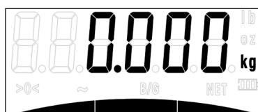
Die Waage startet den Kontrollwägeworgang, sobald das Nettogewicht größer als 10d ist.
